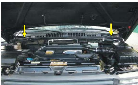
(PL) Podnieść maskę przednią, filtry przeciwpyłkowe znajdują się w symetrycznie rozmieszczonej prostokątnych obudowach
